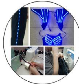
شكل (٢٣) تثبيت شرائط الليدات نيوبيكسل المرنة علي القماش (٢٥) .
